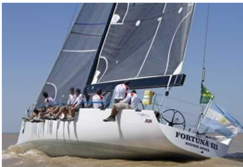
El yate Fortuna III, de la Armada Argentina navegando en una regata entre Buenos Aires y Mar del Plata exhibe su tripulación compensando la escora (inclinación del barco hacia estribor), vela mayor, foque, botavara y timón.
