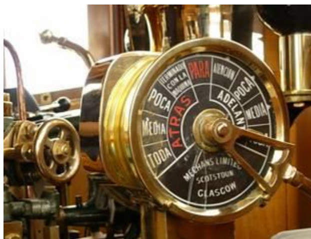
Telégrafo ubicado en el puente de mando para dar órdenes a los maquinistas
