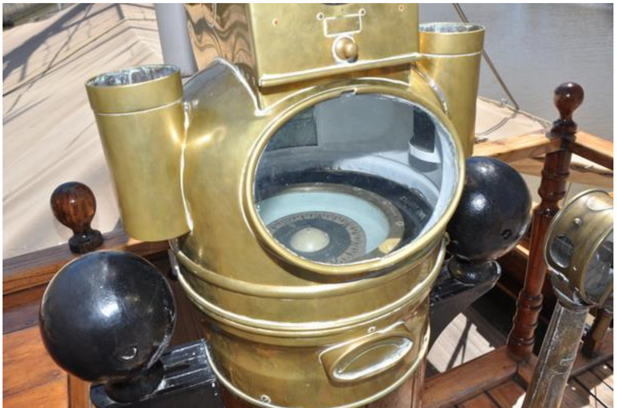
Compás magnético de un buque que permanentemente es observado en su parte interna por el timonel para asegurar el rumbo ordenado por el capitán.
