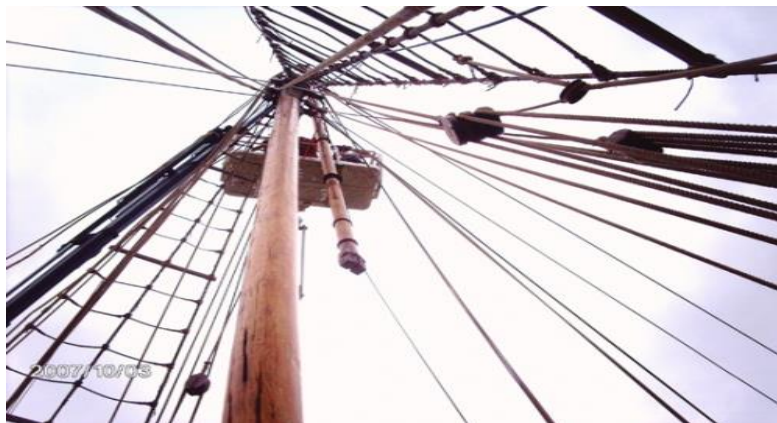
Vista del palo mayor sostenido por los obenques y escalas para los gavieros.
