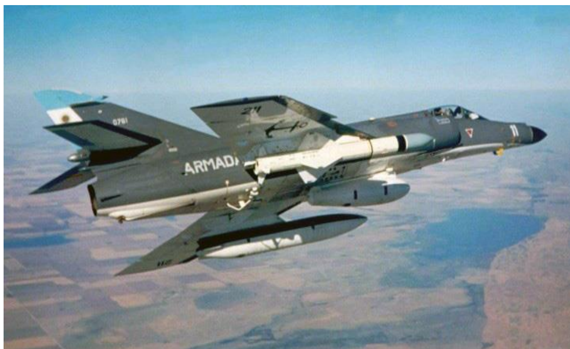
Avión caza de ataque Super Etendart armado con un misil Exocet En una misión durante el Conflicto de Malvinas.
