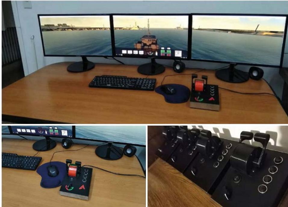
Los controles físicos fueron diseñados y construidos específicamente para el adiestrador ADINAV, reduciendo costos con respecto a las alternativas del mercado.
