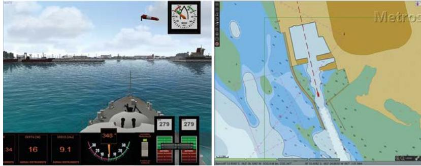
OpenCpn es un software de uso gratuito que se integra al adiestrador mediante conexión Nmea. Este permite la lectura de la cartografía electrónica emitida por el Servicio de Hidrografía Naval.
