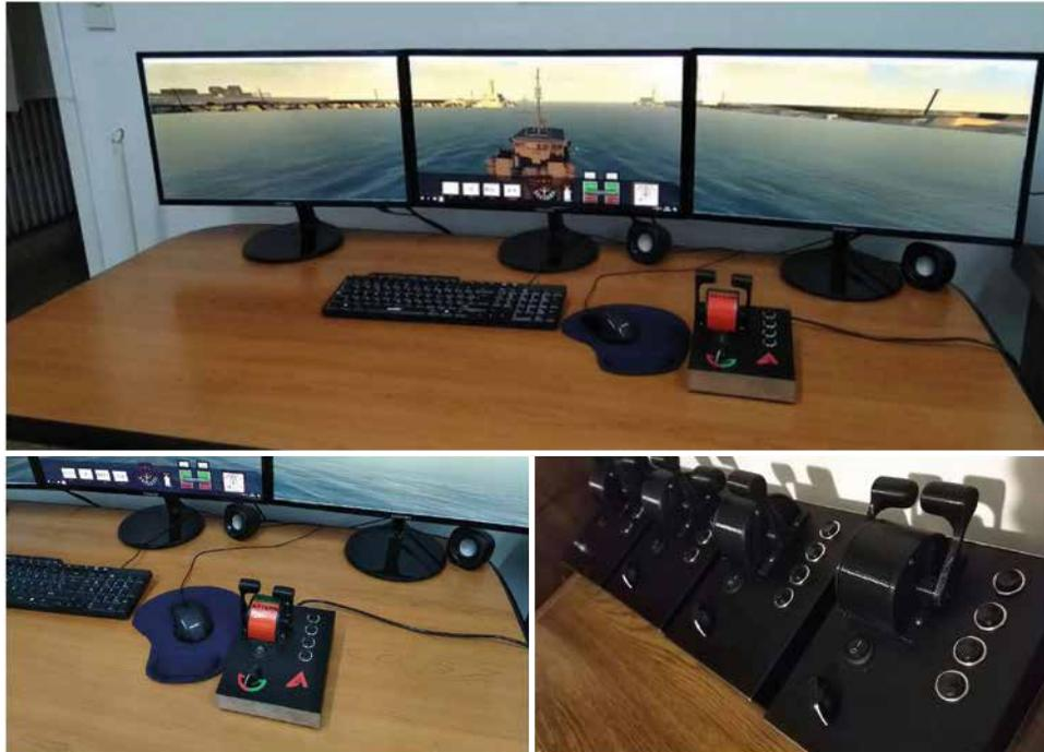
Los controles físicos fueron diseñados y contruidos específicamente para el adiestrador ADINAV, reduciendo costos con respecto a las alternativas del mercado.
