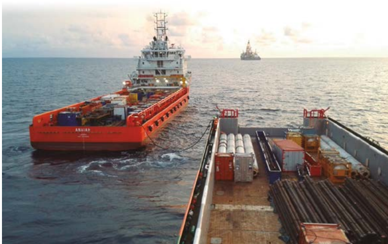
Dos PSV en RAS ( replenishment at sea ) o bunkering cercanos a una plataforma ( rig )
