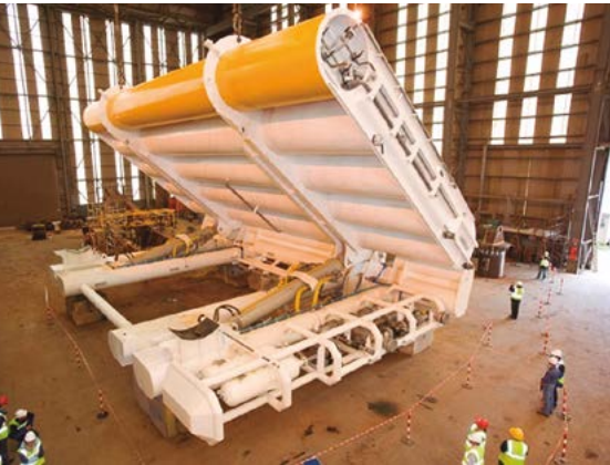
Generadores undiomotriz (izquierda) y de flujo (derecha) terminados, listos para ser trasladados e instalados en el mar
