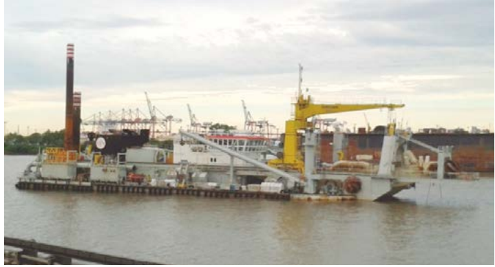
Draga de corte operando en el interior de Dársena Sur
