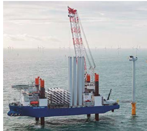
Supply jack-up con grúa, instalando aerogeneradores off-shore
