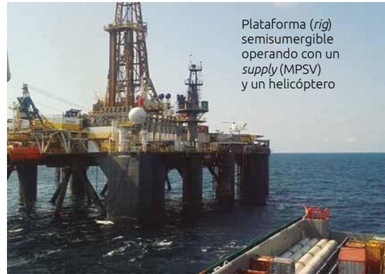
Plataforma (rig) semisumergible operando con un supply (MPSV) y un helicóptero
