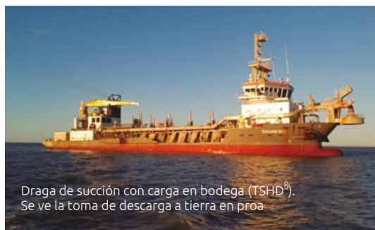
Draga de succión con carga en bodega (TSHD<sup>6</sup>). Se ve la toma de descarga a tierra en proa
