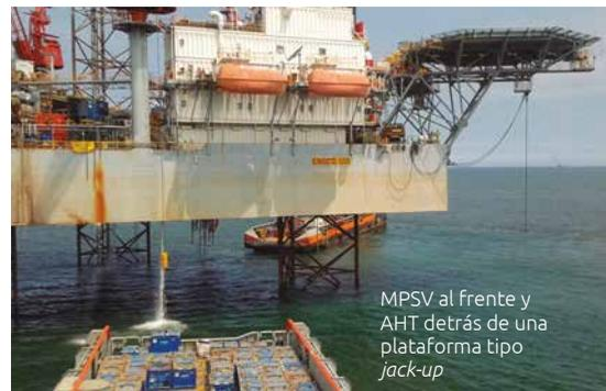
MPSV al frente y AHT detrás de una plataforma tipo jack-up
