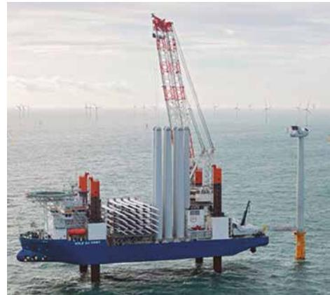
Supply jack-up con grúa, instalando aerogeneradores *off-shore*
