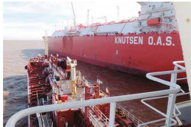
Bunkering a un buque tanque (BT) y a un bulk carrier
