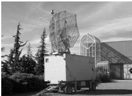
Fotografía N.º 3: Radar francés de la empresa Thomson CSF modelo TRS 2200 (Picador) de 200 millas de alcance usado por Chile durante la Guerra de Malvinas. Probablemente, utilizado desde las proximidades de Punta Arenas.
