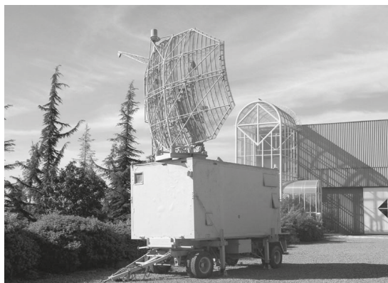
Fotografía N.º 3: Radar francés de la empresa Thompson CSF modelo TRS 2200 (Picador) de 200 millas de alcance usado por Chile durante la Guerra de Malvinas. Probablemente, utilizado desde las proximidades de Punta Arenas.
