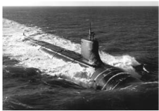
Submarino Seawolf (2004) de los EE. UU. de Norteamérica con un desplazamiento de 9142 t en inmersión (FDRA-NAVAL.BLOGSPOT.COM)
