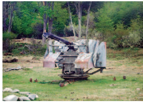
Montaje de 40/60 de Almanza con capa en tubos sobre afuste de Krupp 88. Atrás se nota el albardón de un cañón de 105 mm.
