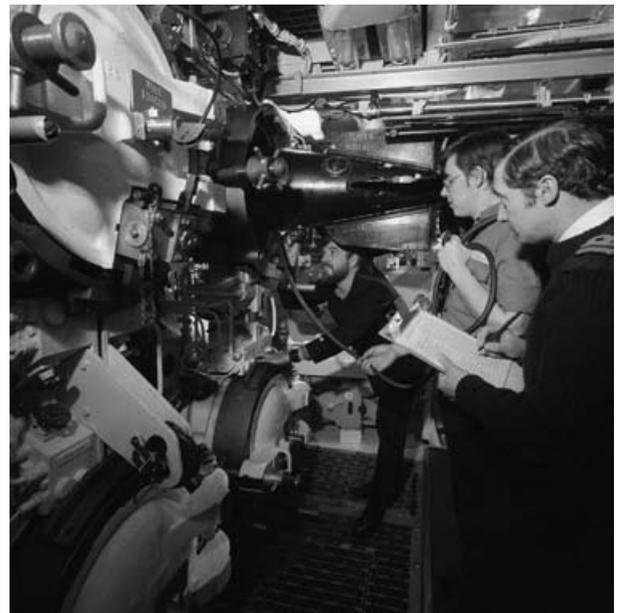
Oficiales británicos controlan la carga de un torpedo Mk. 8 mod 4 en el submarino HMS *Courageous* (IWM)
