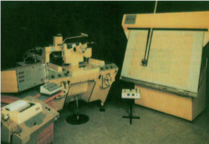
Material automático de cartografía con restitución analógica y estereoscópica del relieve en varias escalas. (A la izquierda: teclado del Terminal y dispositivo de display de las coordenadas planimétricas y altimétricas. A la derecha: mesa trazadora automática del diseño cartográfico.)
