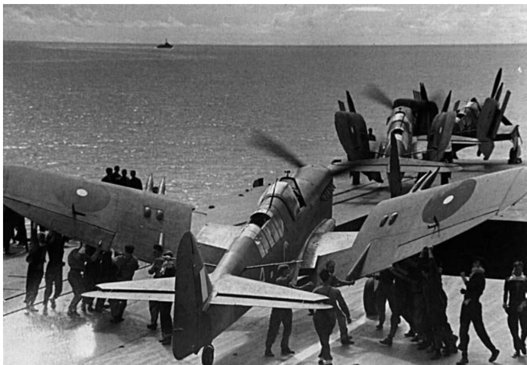
Firefly en la cubierta del HMS Indefatigable . Las alas de este avión debían ser plegadas manualmente por el team de la cubierta de vuelo.
