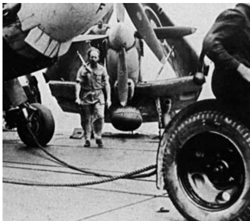
El HMS Implacable . El Capitán de Fragata C. L. Evans, Comandante de vuelo y destacado piloto de caza entre Seafire III del Ala 38. Obsérvese el tanque descartable de 87 galones que permitió mayor autonomía a estos aviones.
