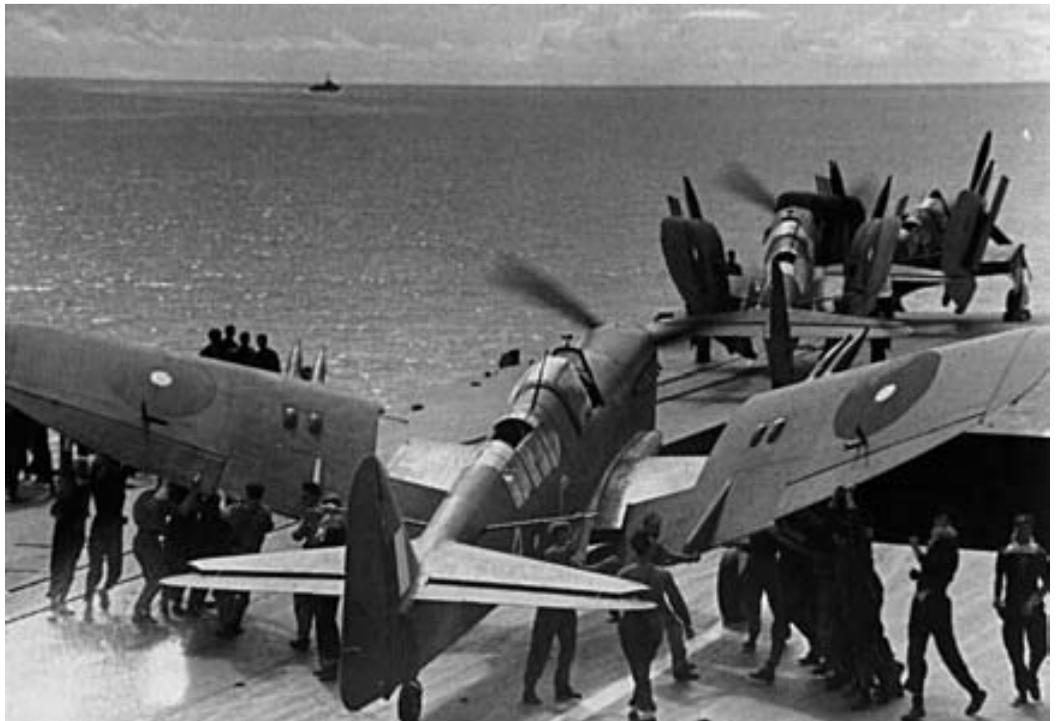
Firefly en la cubierta del HMS *Indefatigable*. Las alas de este avión debían ser plegadas manualmente por el *team* de la cubierta de vuelo.
