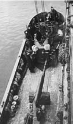
Lancha de desembarco LC 18, antecesora de las lanchas de desembarco mecanizadas, en la foto utilizada para el transporte de una pieza AA de 3,7".
