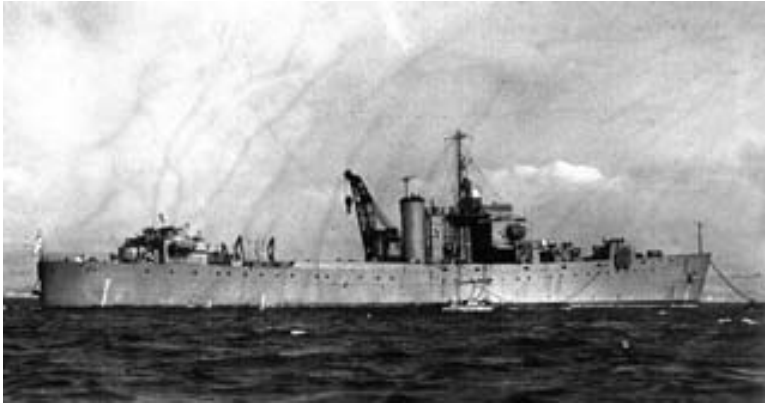
LST (1) Thruster . Fue uno de los cuatro inicialmente construidos en Harland & Wolf. La rampa de proa se extendía por 145 pies y era capaz de soportar el peso de un tanque mediano, de los que tenía capacidad para llevar 13 de ellos.
