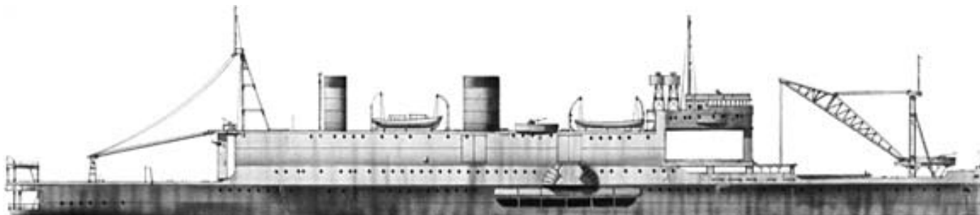
Shinsu Maru . Fue el primer buque construido específicamente para operaciones de desembarco. Botado en 1935, podía llevar 20 lanchas de desembarco que se destacaban desde compuertas en popa. 9.000 toneladas. 150 x 22 m. Dos turbinas sobre dos ejes. 19 nudos. 8 x 76 mm AA. Además de las lanchas, 20 aviones.
