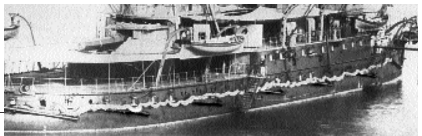
Acorazado francés Indomptable , donde se observa su red antitorpedo plegada y las perchas rebatidas.
