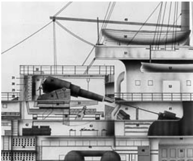
Corte longitudinal de una de las torres del acorazado británico Devastation (puesto en gradas en 1869), en el que se observa el sistema de carga de un cañón de avancarga.
