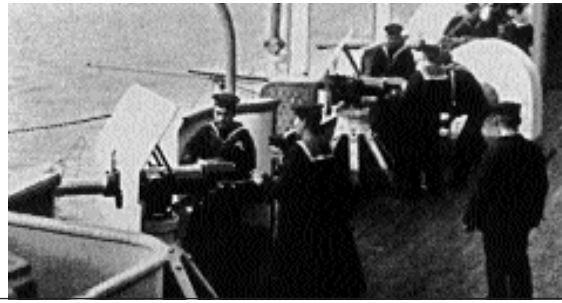
A la izquierda, cañón de tiro rápido de 47 mm de un acorazado británico (1887). A la derecha, cañones de tiro rápido de 57 mm (6 libras; 2,70 kg) de un acorazado británico (1890).
