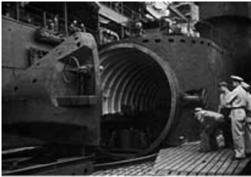
Hangar para hidroaviones bombarderos en el I-400.
