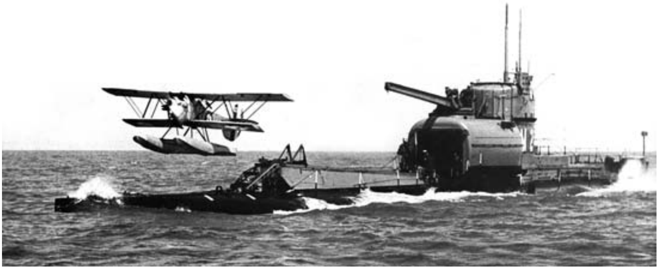
El submarino británico M-2 catapultando un biplano Peto.
