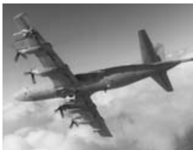
(6) El Orion AIP que mantiene su capacidad antisubmarina, ha sido adaptado para la guerra antiterrestre. Incluye mejoras en C3I, en vigilancia y en capacidad transhorizonte, y fue equipado con misiles aire-tierra Maverick y SLAM (variante del misil antibuque Harpoon).
