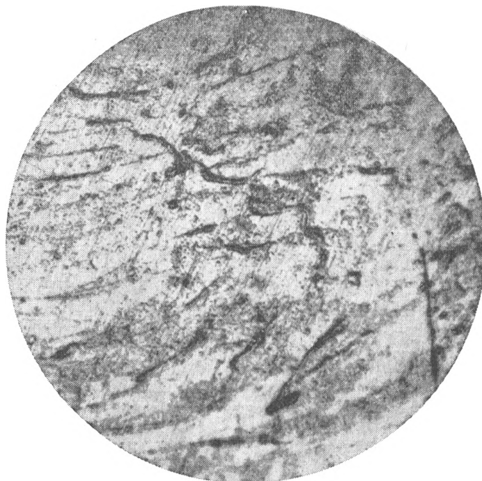
FIG. 5. — Deformación de los planos de clivaje de una estructura metalográfica por efecto de la excesiva tensión aplicada. Aumento 250 X. (Autor)
