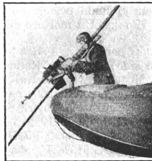
Cañón Davis sin retroceso. (Detalles y cierre: ver Naval Ordnance, Annapolis, 1921).
